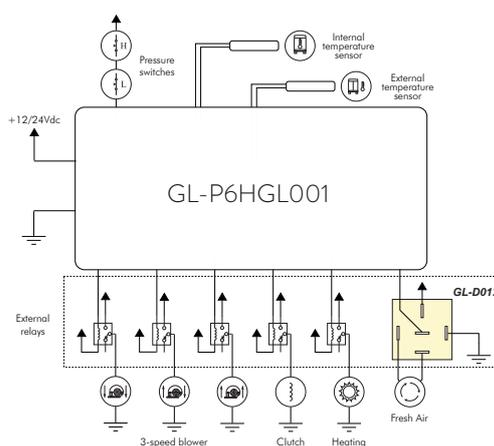
**CONCEITO DE CONTROLADOR HVAC+R | EMBORRACHADO E DISPLAY GRÁFICO OLED**
